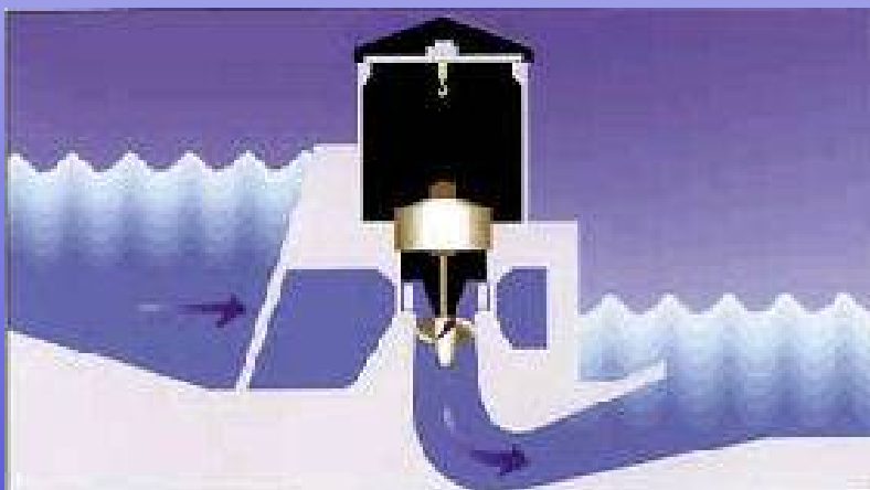
Centrale de basse chute à axe vertical
